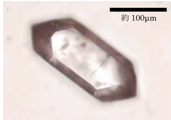
ウラン・トリウム・ヘリウム年代測定に用いたジルコン(鉱物)
